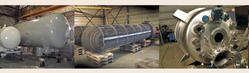
Die Geräte in diesen korrosionswiderstandsfähigeren Materialien werden in Vollmaterial ausgeführt oder nach einer Beschichtungstechnik, bei der ein teures korrosionswiderstandsfähiges Material auf ein relativ kostengünstiges Material, wie Stahl, angebracht wird.
